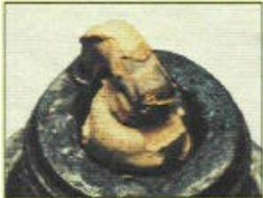
**Électrodes Endommagées** : Électrodes brûlées, vitreuses.
